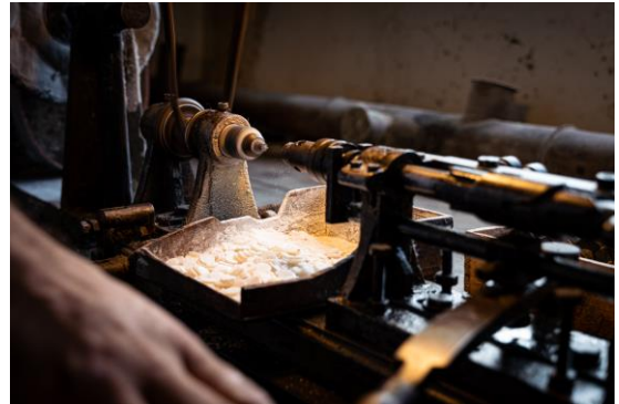
Le perçage des pions, réalisé à l'aide d'un touret muni d'une aiguille, fait la transition entre le pion et le bouton.
